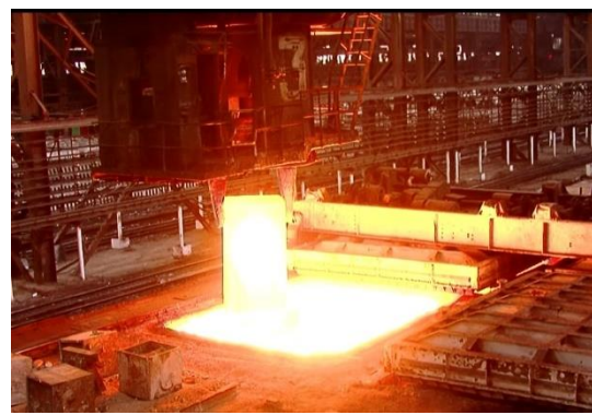
Рис. 2 – Робота колодязного крану під час видачі зливок до прокатки
