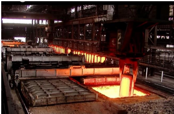
Рис. 1 – Робота колодязного крану під час посадки зливок у колодязі
