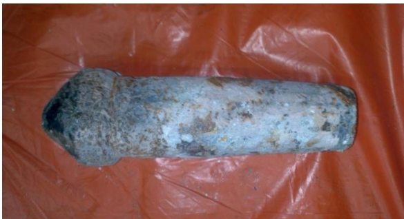
Рис. 6 – Спрацювання робочої частини керна
