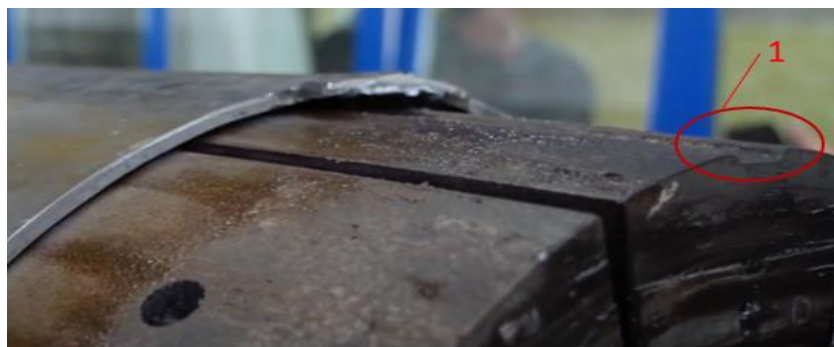
Рис. 3 – Робочий інструмент з повздовжнім пазом для розташування зварного шва: 1 – повздовжній паз (ширина 45 мм, глибина 5 мм)
