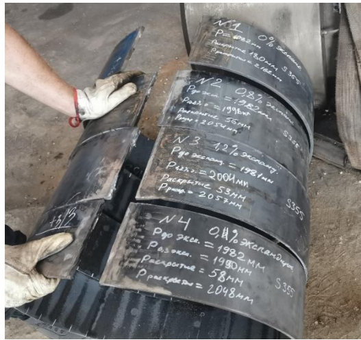
Рис. 4 – Розрізані кільця № 1, № 2, № 3, № 4 від труби розміром 630x8,0 мм
