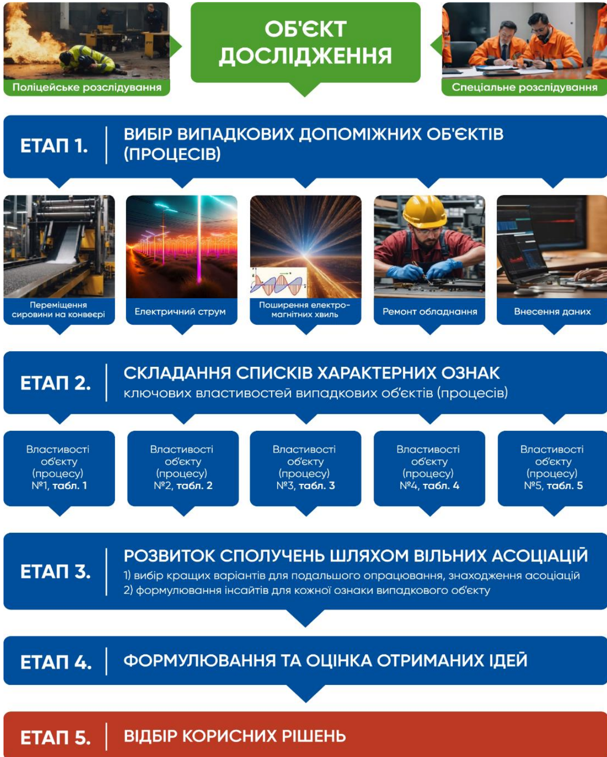
Рис. 2 – Алгоритм методу фокальних об'єктів для удосконалення процесу розслідування нещасного випадку на виробництві
