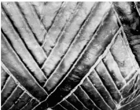
Рис. 8 – Поверхность, наплавленная под углом к образующей
