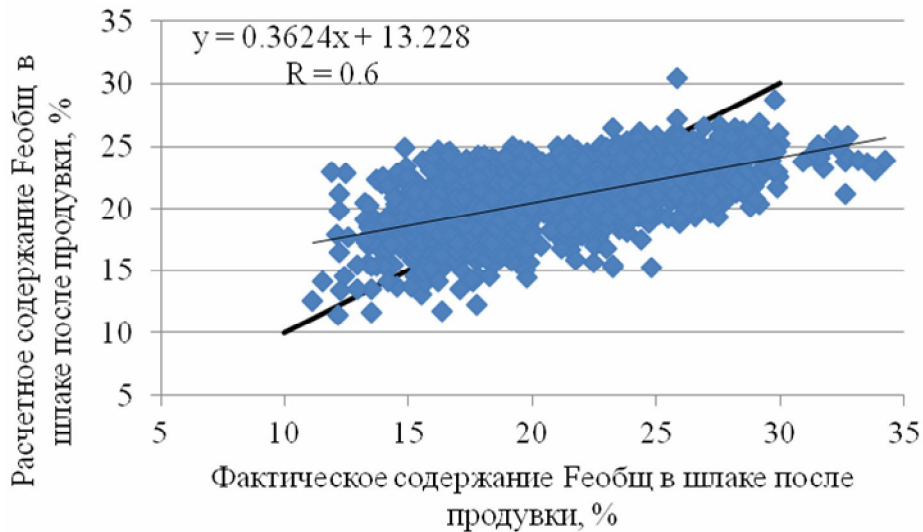
Рис. 5 – Сравнение результатов расчета Fe_{общ} в шлаке после продувки по зависимости (11) с фактическими данными плавки
