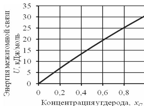
Рис. 3 – Влияние концентрации углерода в  $\gamma\text{Fe}$ -твердом растворе на энергию межатомной связи  $U_k$  при заполнении  $n_C$  комплексов углеродом от 0 до 1
