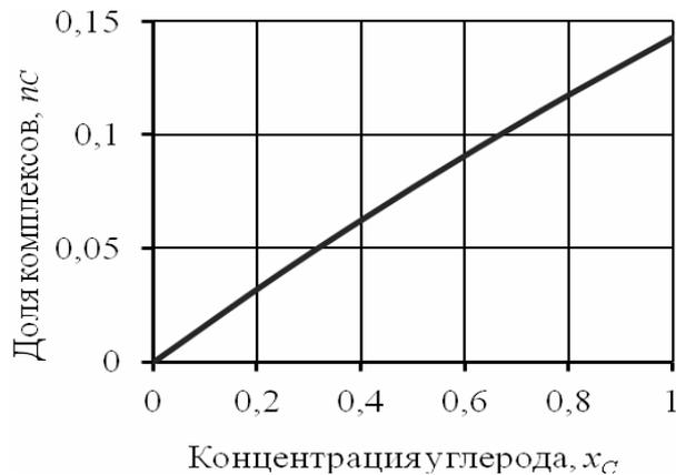
Рис. 1 – Влияние концентрации углерода  $x_C$  на долю заполненных комплексов  $n_C$  в системе  $\gamma\text{Fe}+\text{C}$
