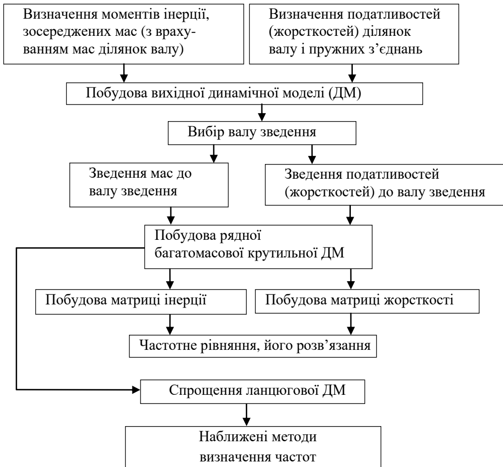
Рис. 2 – Алгоритм для побудови рядної крутильної динамічної моделі і визначення власних частот
