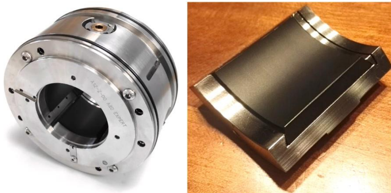
Рис. 11 – Прототип підшипника ковзання з поверхнями ковзання з полімерного матеріалу (ліворуч – повний підшипник, праворуч – сегмент з полімерним матеріалом) [4]
