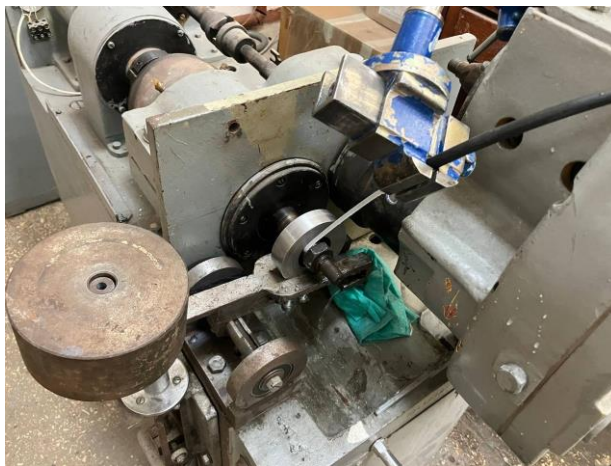
Рис. 16 – Дослідний зразок закріплений в установці для випробувань
