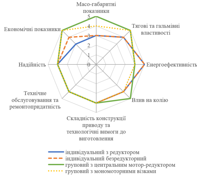
Рис. 7 – Порівняльна діаграма різних типів приводу колісних пар локомотивів
