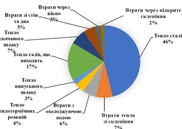
Рис. 1 – Структурна діаграма витрат тепла [1]
