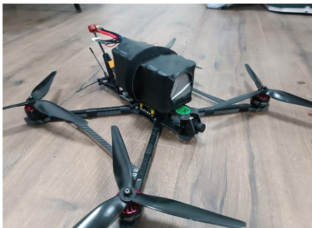
Рис. 1 – FPV-дрон з акумуляторною батареєю 6s3p Molicel P42A
