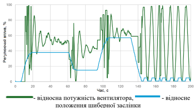
Рис. 28 – Положення шиберної заслінки та потужність вентилятора при регулюванні швидкості повітря
