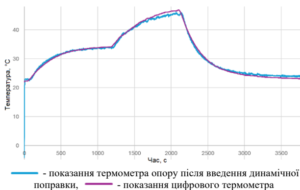
Рис. 17 – Результати вимірювання після введення динамічної поправки
