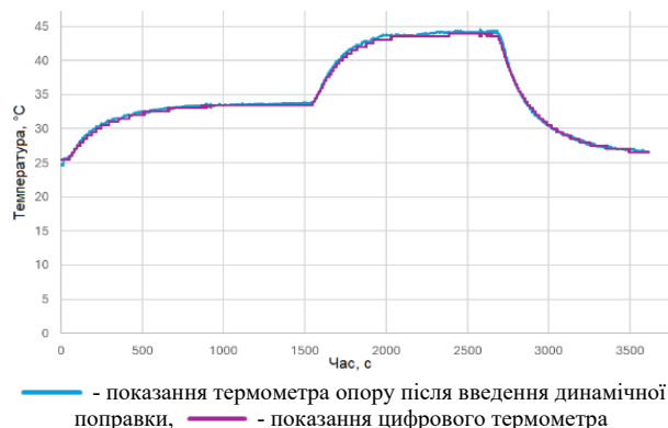
Рис. 18 – Результати вимірювання температури в верхній частині агрегату після введення динамічної поправки
