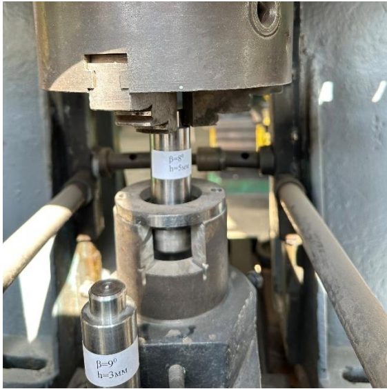
Рис. 5 – Експериментальна установка щодо пошуку оптимальних режимів вібраційної пластичної деформації робочих поверхонь бронзових втулок гідравлічних шестеренних насосів (система пуансон-матриця (розріз))
