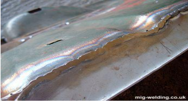
Рис. 1 – Жолоблення кромки при вільному накладанні валика
