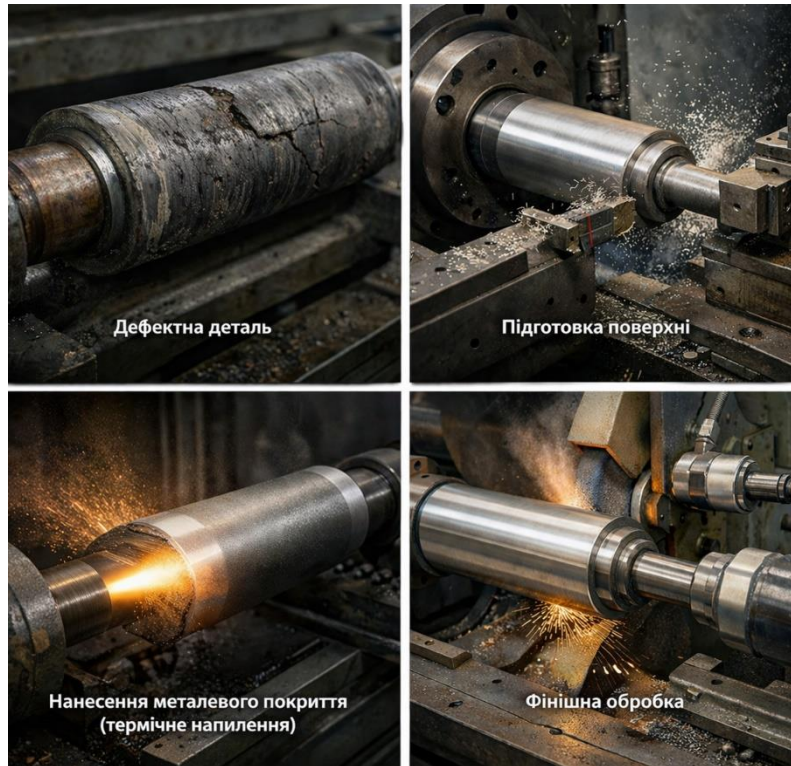
Рис. 2. – Візуалізована послідовність операцій відновлення поверхні окремої деталі від друкарського приладу (зображення згенеровано з авторського ескізу у цифровому середовищі Adobe Firefly)
