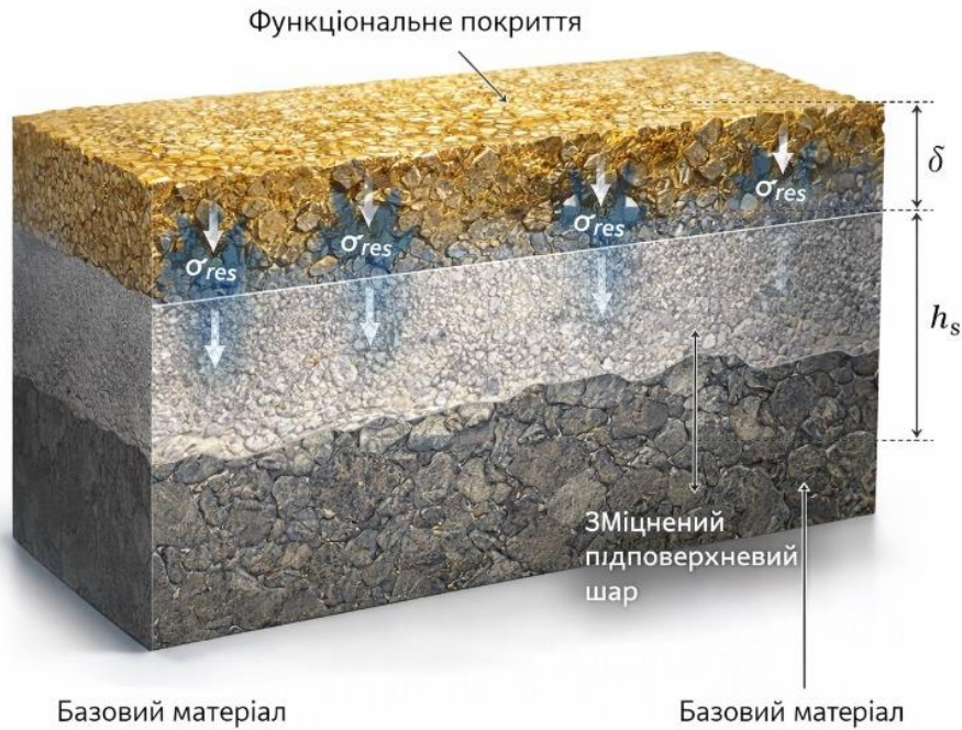
Рис. 3 – Модель поверхневого шару після комбінованого зміцнення з відображенням глибини зміцнення та розподілу залишкових напружень (зображення згенеровано з авторського ескізу у цифровому середовищі Adobe Firefly)
