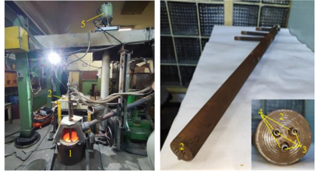
Рис. 1 – Багатофункціональна установка високотемпературного моделювання процесу підігріву металобрухту перед заливанням рідкого чавуну (а) з використанням паливно-кисневої фурми (б): 1 – модель конвертера; 2 – верхня киснева (або паливно-киснева) фурма; 3 – паливні сопла; 4 – кисневі сопла; 5 – паливний живильник [7]
