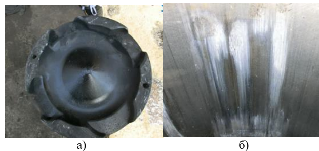
Рис. 5 – Заклинювання поршню в гільзі циліндру: а – поршень, який заклинило; б – сліди заклинювання на гільзі циліндру
