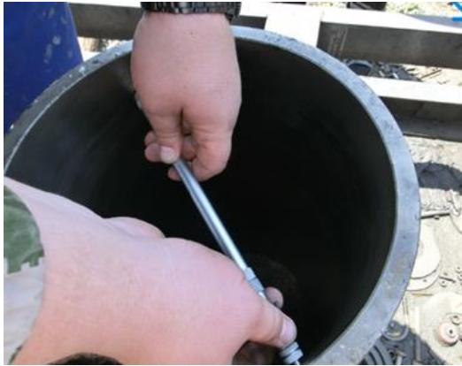
Рис. 7 – Обмір параметрів циліндро-поршневої групи
