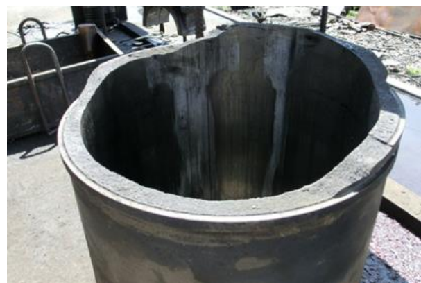
Рис. 6 – Обрив гільзи циліндру
