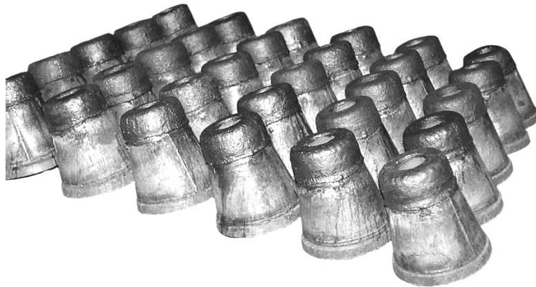
Рис. 1 – Внешний вид партии ВДФ с чугунным защитным покрытием носков
