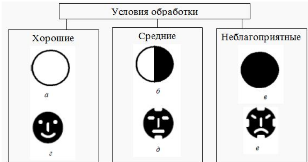
Рис. 2 – Обозначения различных условий обработки: а–в – фирма Sandvik Coromant; г–д – фирма Walter; а, г – хорошие условия; б, д – средние условия; в, е – неблагоприятные условия
