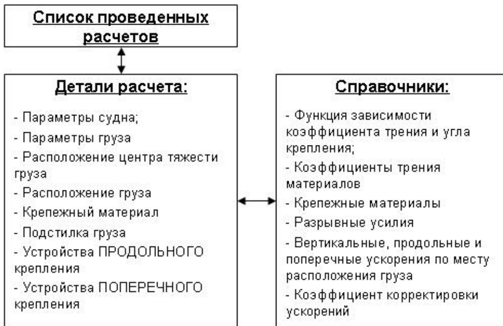
Рис. 3 – Структура информационной базы данных программы расчета
