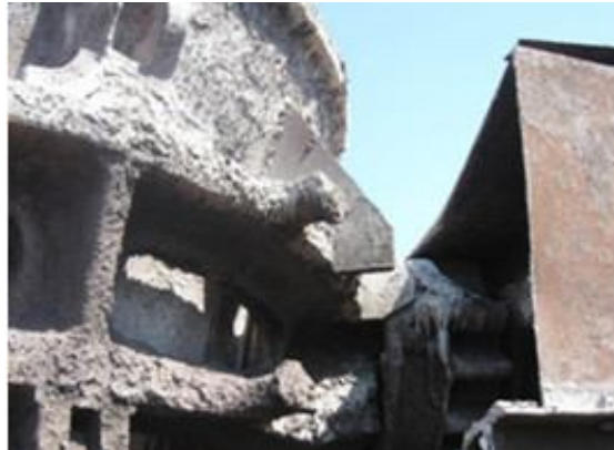
Рис. 5 – Фрагмент чаши с приваренными ребрами жесткости
