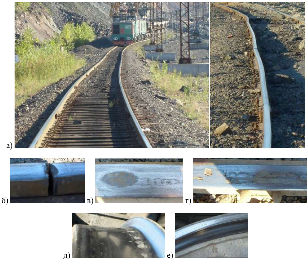
Рис. 5 – Фрагменти стану рейкового полотна і стану колісних пар: а – загальний вигляд; б – розрив; в – виїмка; г – вищербленість; д – зміна діаметра колеса; е – вищербленість колеса
