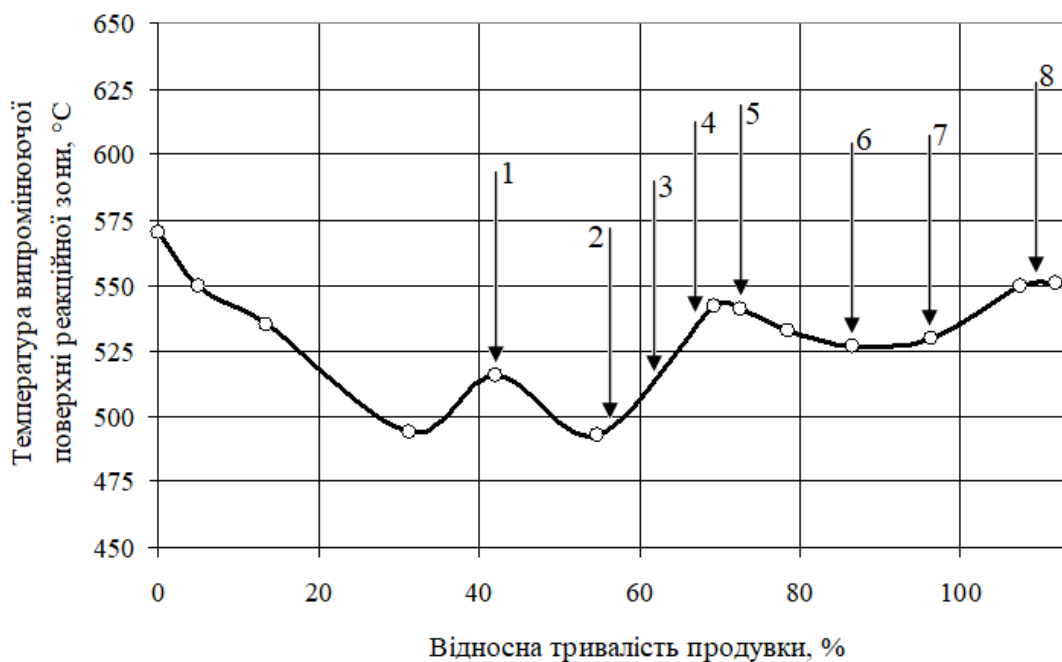
Рисунок – Зміна температури випромінюючої поверхні реакційної зони в різні періоди плавки в конвертері: 1 – інтенсивне окислення Fe при слабкому перемішуванні; 2 – початок активного окислення [Mn], [Si]; 3 – ендотермічні процеси окислів Fe в шлаці; 4 – уповільнення росту температури через активне перемішування ванни; 5 – падіння температури через зменшення вмісту вуглецю в металі; 6 – погіршення перемішування; 7 – зростання температури на 2-3°C в хвилину; 8 – стабілізація температури
