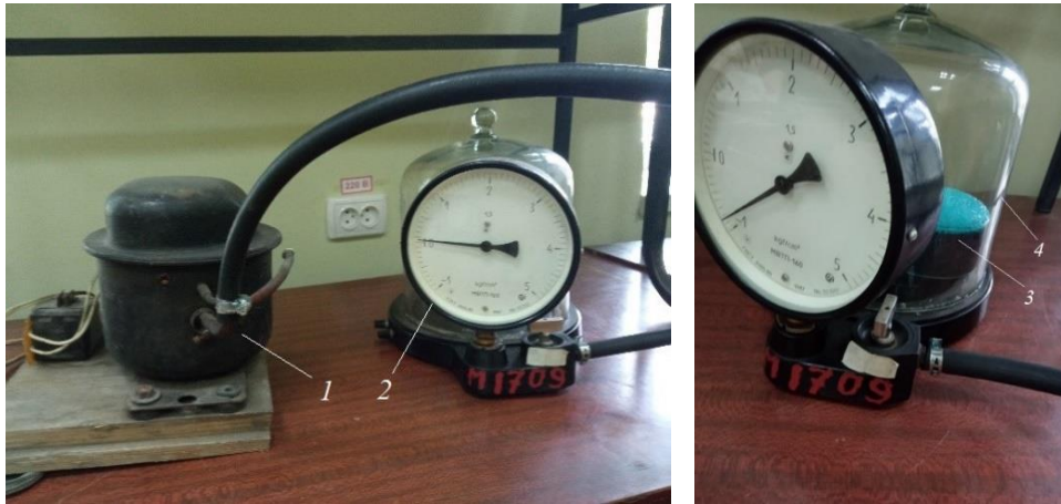
Рис. 2 – Фото установки для створення розрідження: 1 – компресор; 2 – манометр; 3 – скляна ємність; 4 – ємність із зануреними в забарвлену рідину зразками
