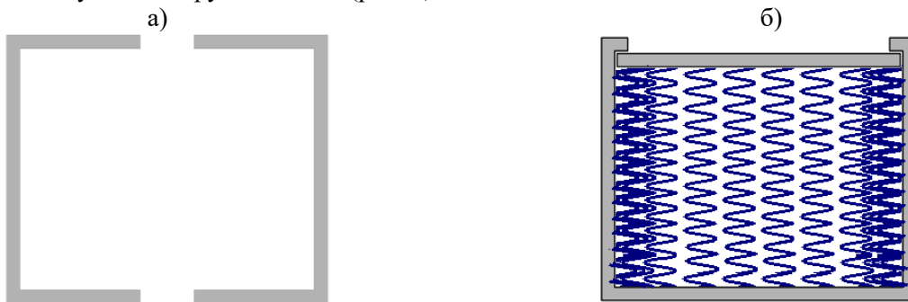
Рис. 1 – Переріз хребтової балки вагона-цистерни: а) типова хребтова балка; б) хребтова балка з пружними елементами
