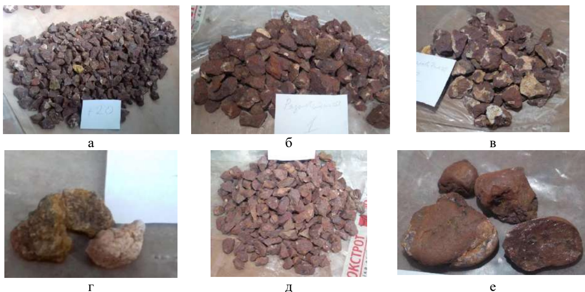
Рис. 3 – Матеріал класу крупності 20-40 мм: а – загальний вигляд; б-д – мінералого-петрологічні різновиди: б – мало-глинистий; в – середньо-глинистий; г – глинистий; д – убого-глинистий, е – уламки кварцу
