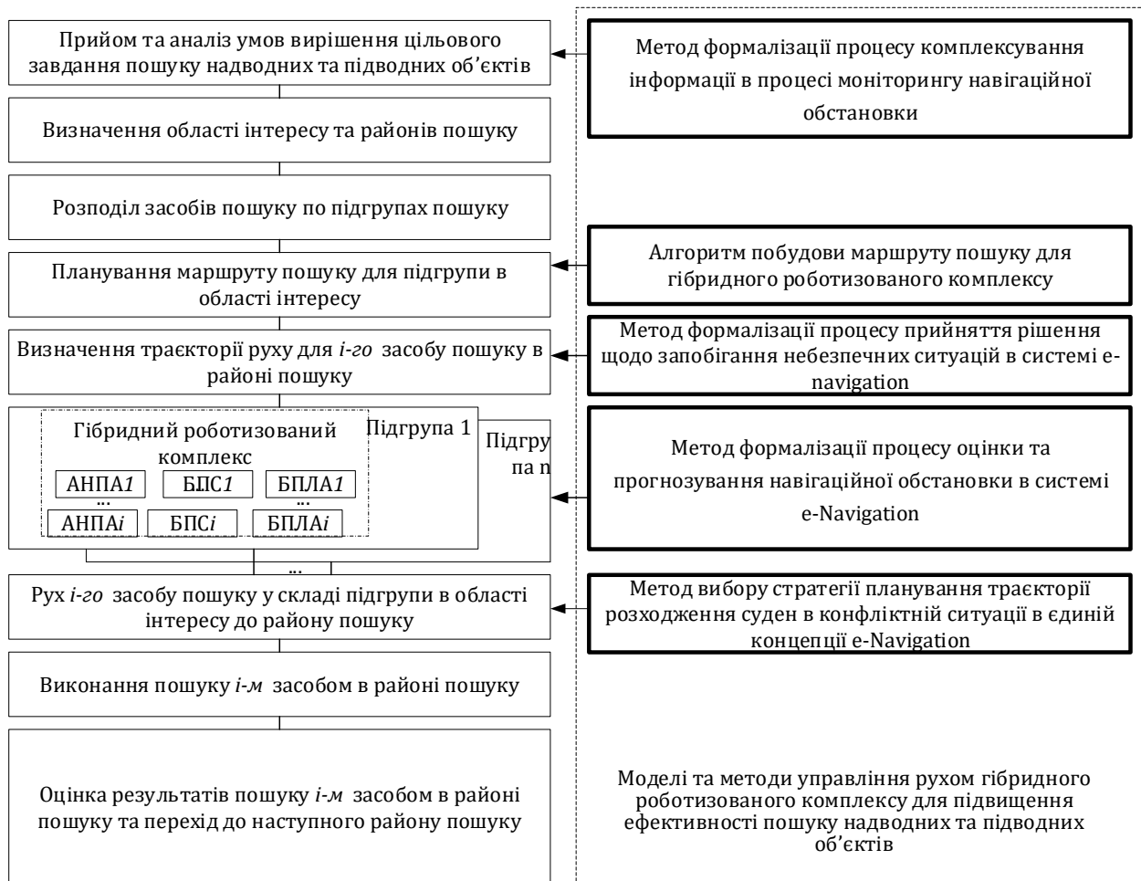
Рис. 2 – Удосконалений метод управління пошуком надводних та підводних об'єктів гібридним роботизованим комплексом (джерело: розроблено автором)
