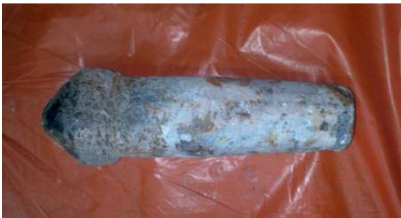
Рис. 6 – Спрацювання робочої частини керна
