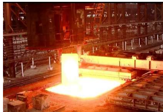
Рис. 2 – Робота колодязного крану під час видачі зливків до прокатки
