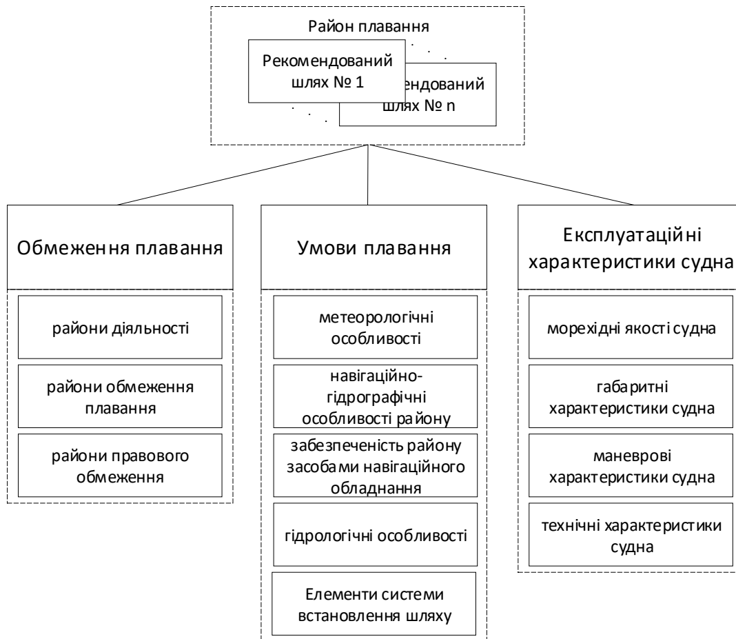
Рис. 1 – Взаємозв’язок між типовими районами водних просторів за маршрутом переходу судна, особливостями судноплавства в цих районах та експлуатаційними характеристиками судна
