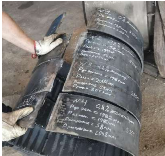
Рис. 4 – Розрізані кільця № 1, № 2, № 3, № 4 від труби розміром 630x8,0 мм
