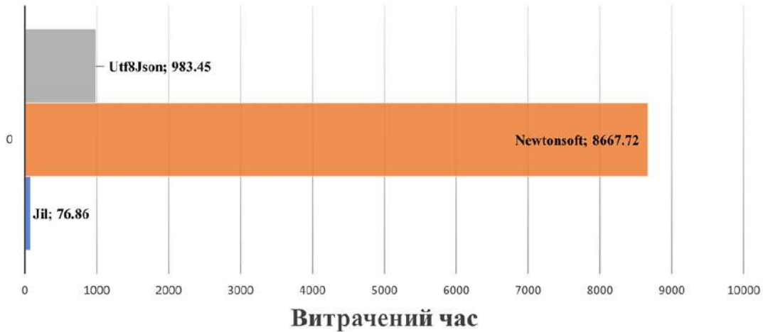
Рис. 13 – Діаграма витрат часу при серіалізації об'єкта, що містить тривимірний масив натуральних чисел
