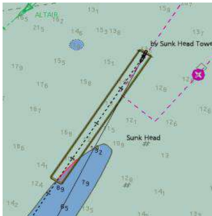
Рис. 10 – Індикація тривоги є при перетинанні Safety frame ізобати Safety Contour [1]
