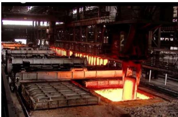
Рис. 1 – Робота колодязного крану під час посадки зливків у колодязі
