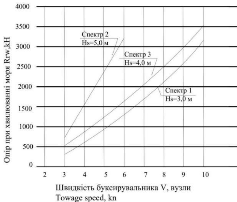
Рис. 2 – Залежність буксирного опору маломорехідного об'єкту від швидкості буксування з урахуванням хитавиці
