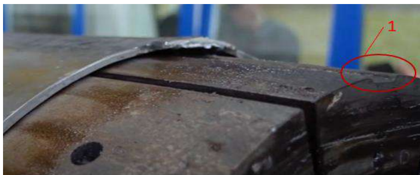
Рис. 3 – Робочий інструмент з повздовжнім пазом для розташування зварного шва: 1 – повздовжній паз (ширина 45 мм, глибина 5 мм)
