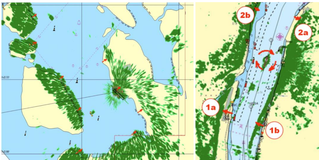
Рис. 4 – Зміщення радіолокаційного зображення через помилки в обчисленні під час суміщення та помилку датчика курсу судна [2]
