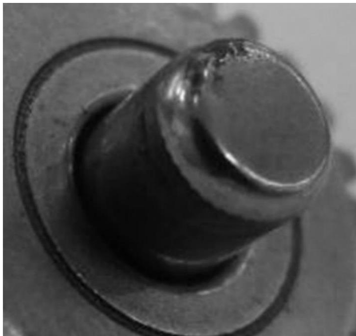
Рис. 15 – Досліджуваний підшипник ковзання [19]
