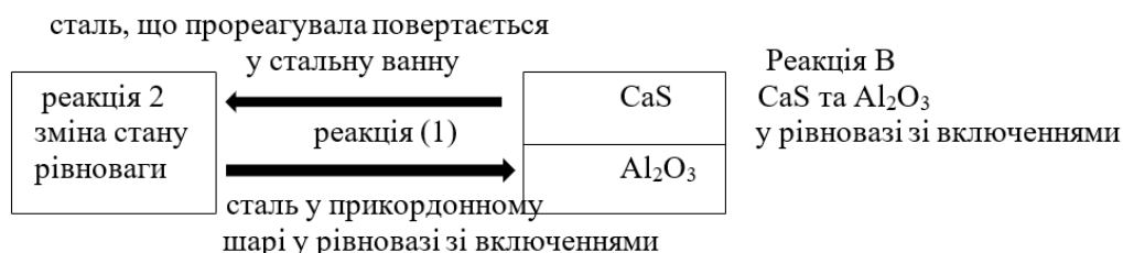
Рис. 2 – Діаграма потоку, яка ілюструє принцип кінетичної моделі для локальної рівноваги з включеннями та обмеженого масопереносу між розплавом сталі зі включеннями та основним розплавом сталі. Реакції А та В відбуваються один раз для початкових умов, а реакції 1 та 2 відбуваються багатократно на кожному інтервалі часу
