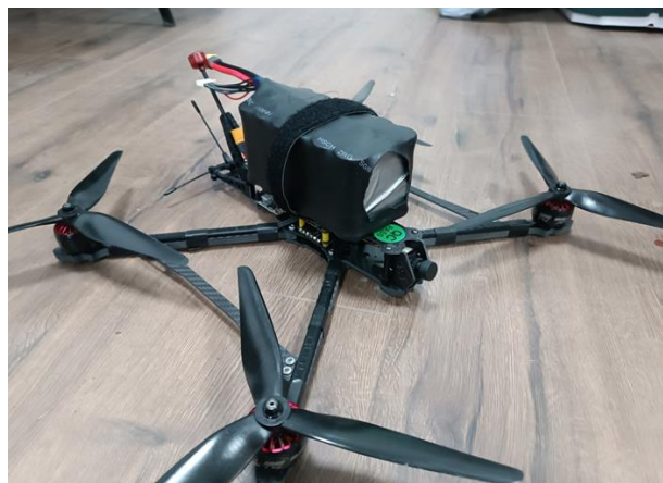
Рис. 1 – FPV-дрон з акумуляторною батареєю 6s3p Molicel P42A
