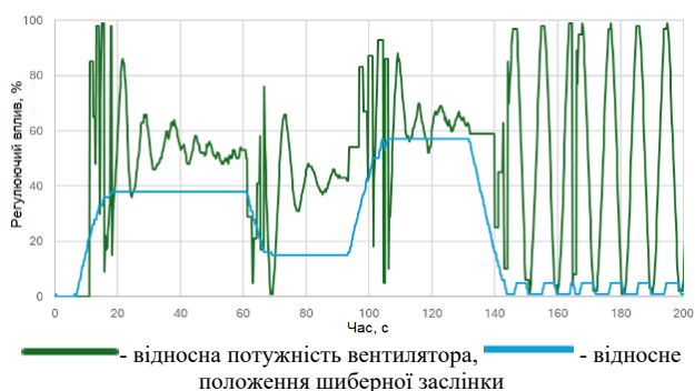
Рис. 28 – Положення шибєрної заслінки та потужність вентилятора при регулювання швидкості повітря
