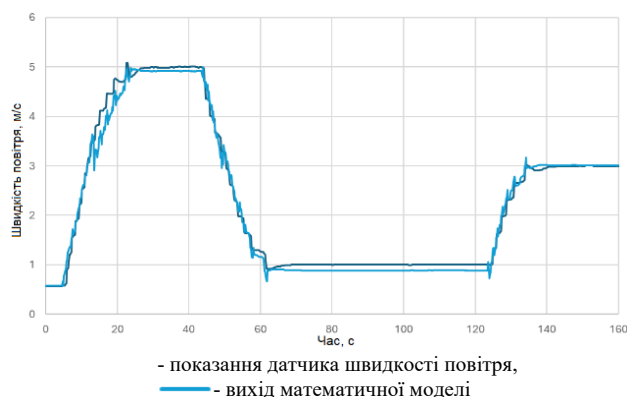
Рис. 34 – Порівняння реальної швидкості повітря на виході з димового тракту з результатами моделювання при змінних параметрах об'єкту
