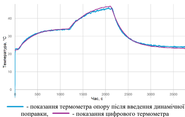
Рис. 17 – Результати вимірювання після введення динамічної поправки
