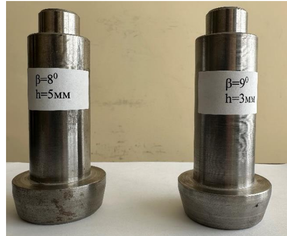
Рис. 4 – Приклад виготовленого експериментального пуансону, що було використано для обробки тиском – вібраційним пластичним деформуванням робочих поверхонь бронзових втулок підшипників ковзання шестеренних валів гідравлічних насосів
