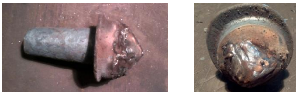
Рис. 5 – Зовнішній вигляд керна після наплавлення
