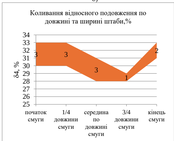
Рис.4 – Графік коливання механічних властивостей сталі марки 3пс по довжині та ширині штаби: а) межа плинності; б) межа міцності; в) відносне подовження
