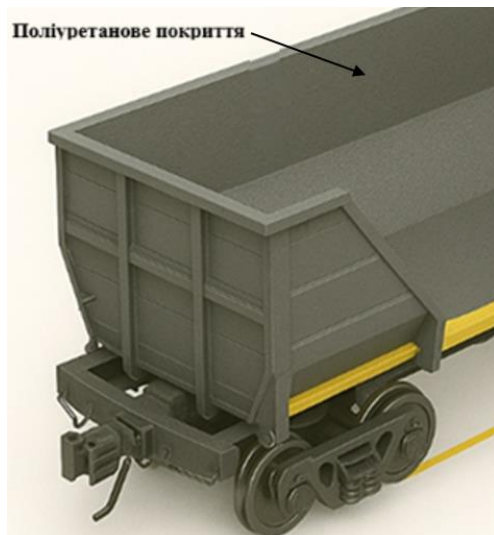
Рис. 1 – Напіввагон з поліуретановим композиційним покриттям
